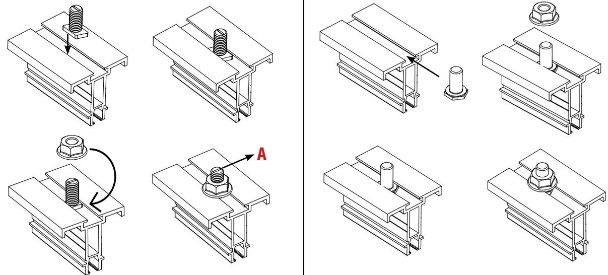
Am Fußende der Rhombusschraube befindet sich ein Schlitz. Die senkrechte Aufstellung des Schlitzes zur Profilmutter (Schema **A**) gewährleistet, dass der Schraubenkopf richtig eingesetzt ist.
