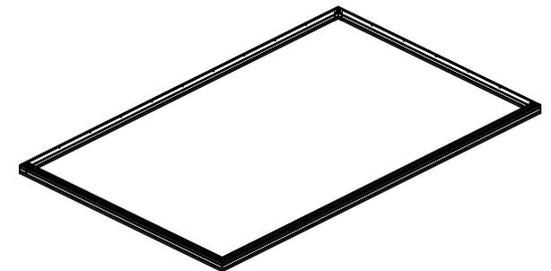
**Befestigen Sie Ihr Fundamentrahmen dauerhaft nach vollständiger Montage der Aluminium-Konstruktion (außer Türen und Fenster) auf einer ebenen und rechtwinkligen Fläche.**
