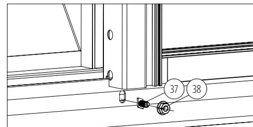
**Die untere Türschiene wird am Ende installiert. Das richtige Einsetzen garantiert ein gutes Gleiten der Tür.**
