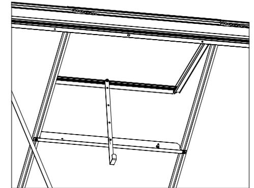
Bei starkem Wind kann sich der manuelle Fensteröffner, obwohl dieser in geschlossener Stellung liegt, rausheben und öffnen (möglicherweise sogar aus dem First fallen). Um dies zu vermeiden empfehlen wir den manuellen Fensteröffner mit der Mutter (55) und der Schraube (38) zu befestigen.
