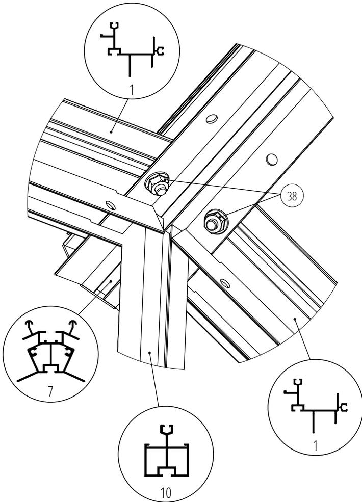
**2** Windverbände montieren :
