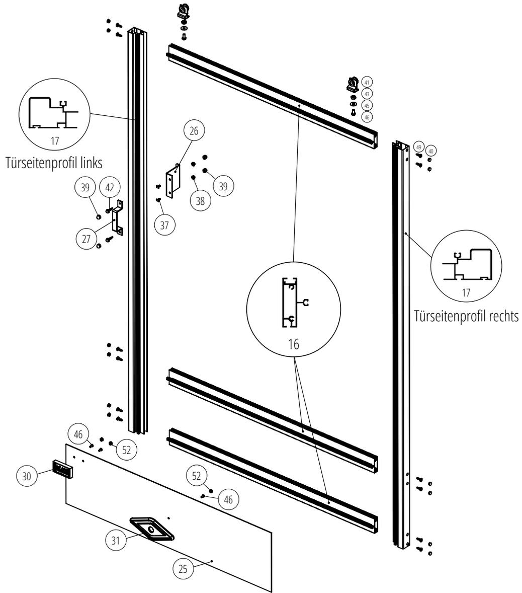
Die Zwischenschienen wie folgt aufstellen, damit diese gut in der unteren Türschiene gleiten kann.
