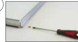
Schrauben Sie die Schrauben mithilfe eines Schraubenziehers fest und nicht mit einem Akkuschauber.
