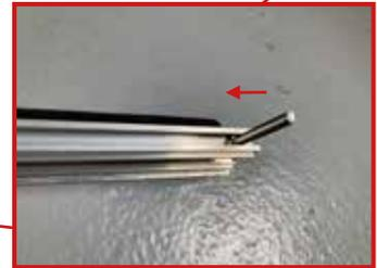
**Gleiten Sie die Schraube M6x40 (34) ins Profil (0)**
